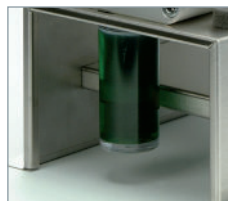
Lukket returbeholder til støvopsamling og videre deponering
