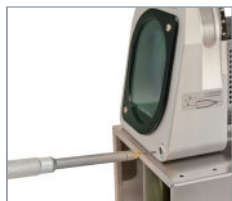
Præcis længdebestemmelse af elektrodens stick-out
